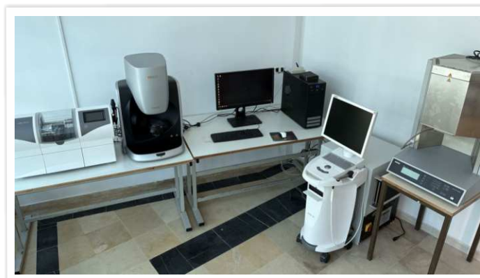
Chaîne CFAO directe intégrée comprenant scanner intra-oral, unité de conception numérique, scanner de laboratoire, unité d'usinage quatre axes et four de frittage/cristallisation.
