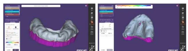
Figure 12 Blocage des contres dépouilles et de traçage des limites de la prothèse complète amovible par les options Add/remove et Smooth/flatten.
